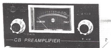
P 27 ONTVANGSTVERSTERKER Frequentiebereik 26,7 - 27,5 Mhz Versterking 25 dB Voedingsspanning 10 - 15 Volt Stroomverbruik 1 mA Maximaal belastbaar 100 watt AM - SSB - FM Afmetingen 160 x 80 x 120mm
